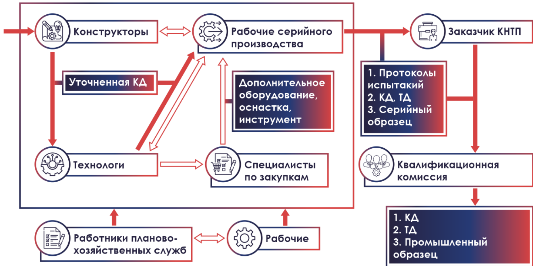
Рисунок Д.16 – Схема действий (алгоритм) подготовки и освоения производства (постановки на производство) продукции
